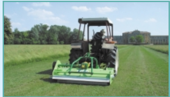
(B) - Coltello a paletta robusto di spessore 5 mm per erba e piccoli arbusti. - Heavy duty paddle Flail with 5mm thickness for grass and small branches. - Fléau -palette robuste, épaisseur 5 mm, pour herbe e petits arbustes - Schwere Bechermesser, 5 mm für hohen Gras und dünnen Heckenschnitt.
